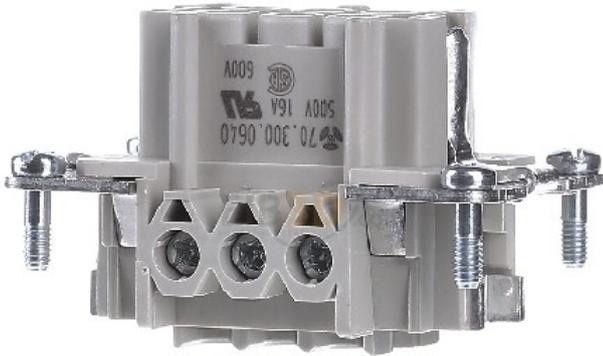
Versione contatti Presa, Numero di poli 6, Corrente nominale In 16 A, Temperatura ambiente -40..120 °C, Temperatura di esercizio -40..120 °C, Tensione nominale 500 V, Tensione nominale di transitorio 6 kV, Grado di sporcizia 3, Con protezione filo sì, Materiale del rivestimento di contatto Stagno, Con conduttore di protezione sì, Larghezza 34 mm, Altezza 32 mm, Profondità 50,5 mm
