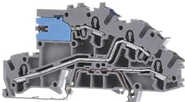
Corrente nominale In 32 A, Tensione nominale 250 V, Numero di potenziali 3, Tipo di montaggio Guida DIN TH35, Materiale del corpo isolante Termoplastico, Temperatura di esercizio 105 °C, Larghezza 5,2 mm, Altezza 96 mm, Profondità 42,3 mm, Necessaria piastra di chiusura sì, Colore di base grigio, Con funzione PE sì, Con cursori di sezionamento del neutro senza vite sì, Funzione N possibile sì
