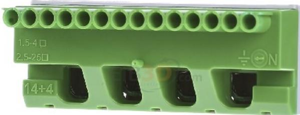
Cantidad de puntos de embornado 18, Sección nominal 1,5..25 mm<sup>2</sup>, Diámetro del cable 25 mm, Con palancas de accionamiento no, Color verde, Transparente no, Tensión nominal 230 V, Intensidad nominal 63 A, Apto para conductor macizo sí, Apto para conductores flexibles sí, Apto para conductores multifilares sí, Rango AWG 4..16
