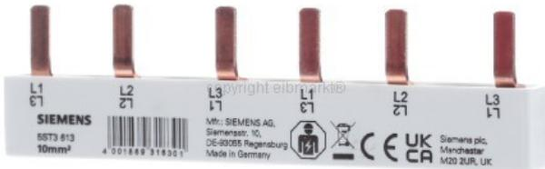
Cantidad de fases 3, Sección 10 mm<sup>2</sup>, Longitud 102,5 mm, Corriente constante nominal Iu 63 A, Diseño de la conexión eléctrica Clavija, Aislado sí
