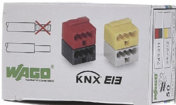
Cantidad de puntos de embornado 8, Diámetro del cable 0,6..0,8 mm, Con palancas de accionamiento sí, Color rojo/gris oscuro, Transparente no, Tensión nominal 100 V, Intensidad nominal 6 A, Apto para conductor macizo sí, Apto para conductores flexibles no, Apto para conductores multifilares no, Rango AWG 22..20
