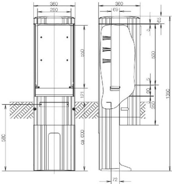
**Placa de montaje de columna exterior
