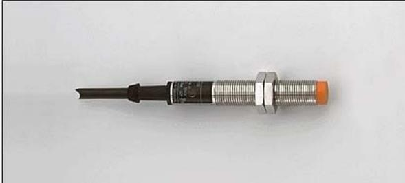
Anchura del sensor 12 mm, Altura del sensor 71 mm, Longitud del sensor 12 mm, Distancia de conmutación 4 mm, Diseño de la salida de conmutación PNP, Forma constructiva de la carcasa Cilindro, rosca, Intensidad de salida máx. en la salida segura 0,25 mA, Tensión de alimentación 10..36 V, Tensión de alimentación de mando nominal Us con CC 10..36 V, Tipo de tensión CC, Material de la carcasa Metal
