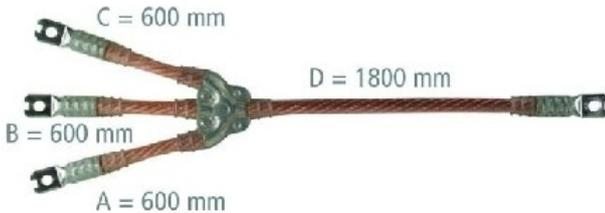
Versión Cable, Número de polos 3, Corriente de cortocircuito máx. 33,5 kA, Sección del cable, lado de fase 120 mm<sup>2</sup>, Sección del cable, lado de tierra 120 mm<sup>2</sup>, Longitud cable de fase a 600 mm, Longitud cable de fase b 600 mm, Longitud cable de fase c 600 mm, Longitud cable de tierra 1800 mm, Elemento de conexión lado de la fase sin, Elemento de conexión lado de la tierra sin, Totalmente aislado no, Material Cobre
