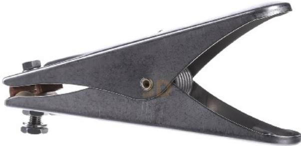
Erdungszange L 205mm NIRO 546 001 Geeignet für Rund-/Flachleiter, Klemmbereich Rundleiter 1 ... 55mm, Klemmbreite Flachleiter über 40 mm, Werkstoff rostfreier Stahl, Oberfläche unbehandelt, Erdungszange zur kontrollierten Erdung / ableiten statischer Aufladung von Tankwagen, Flugzeugen, Containern und Behältern. Auch für die Anwendung in explosionsgefährdeten Bereichen geeignet. Ausführung groß, Messingbacke ohne Stahlspitzen und Kontaktbügel aus Kupfer. Anschluss: Gewindebolzen M10 mit Mutter.
