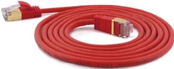
SSTP-Patchkabel Cat.6A rt 5,0m Steck. 4mm 7163 rt 5,0m Länge 5m, Mantel-Farbe rot, Extra dünnes, rundes SSTP Patchkabel mit CAT7 Kabel, Stecker CAT6a, Außen-Ø=4 mm/vergoldete RJ45 Stecker, getestet mit 600 MHz Datenrate, erfüllt alle CAT7 ANSI/TIA-568-C.2 Standards, normkompatibel zu CE, RoHS, Reach Standards
